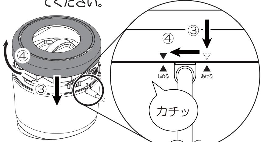
※共回りを防ぐために、本体上部、または取手を押さえながら、フィルターカバー大を回してください。必ず“しめる”の位置まで回してロックをしてください。
