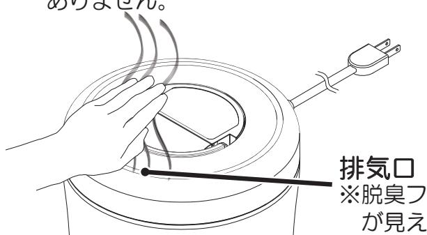
2. 温風確認後、電源ボタンを押して本体の電源を切り、試運転終了となります。これで生ごみ乾燥処理の準備が整いました。
