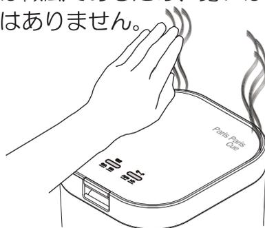
2. 排気確認後、電源ボタンに触れ、本体の電源を切り試運転終了となります。これで生ごみ乾燥処理の準備が整いました。
