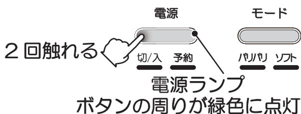
2. 運転モードを選択し、選択されたモードランプが点滅から点灯に変われば、3時間後に運転が開始されます。
